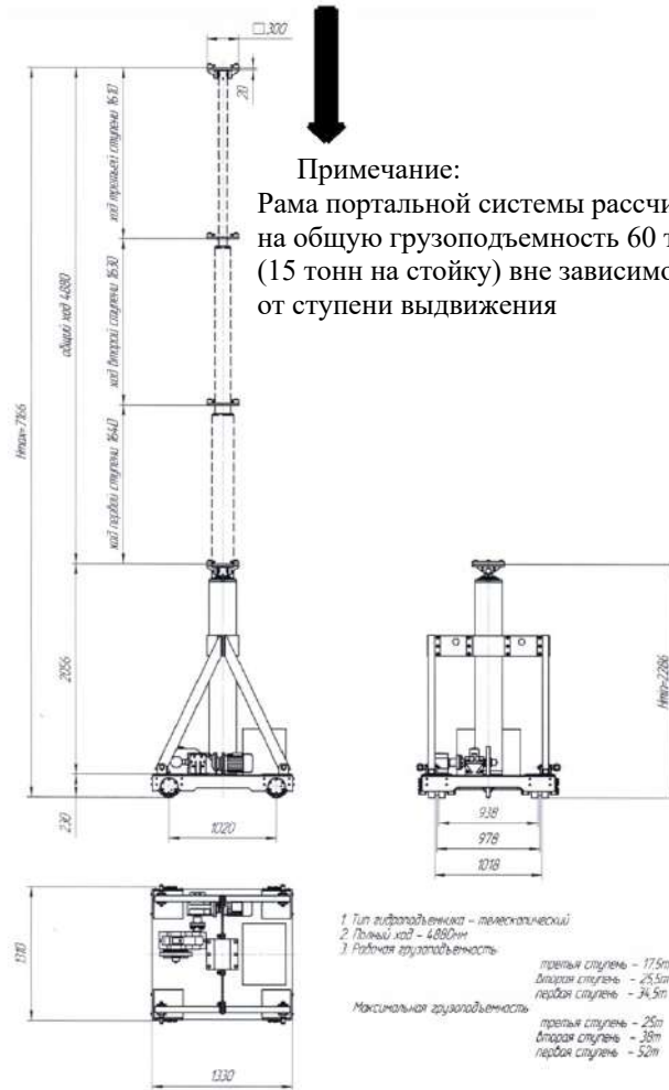
Габаритные размеры стойки МПК.4.60.4880. Рис.3.1
