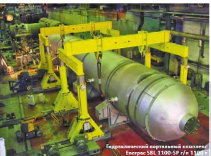
Гидравлический порталный комплекс Enerpac 58L 1100-SP г/п 1100 т
